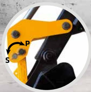
Высокоэффективный ковш экскаватора можно установить на две разные точки на плече экскаватора. Это позволяет оператору изменять положение штифта по мере необходимости и работать с большей **мощностью (P)** или большей **скоростью (S)** во время выполнения работ.
